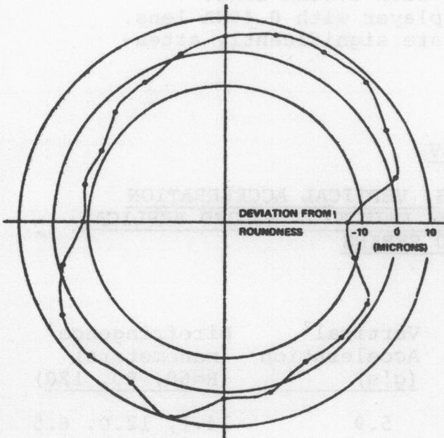
FIG. 2: OUT-OF-ROUNDNESS OF INJECTION MOLDED REPLICA 558-000-134 MEASURED AT R=145mm. MAXIMUM RADIAL ACCELERATION: 0.9g.
